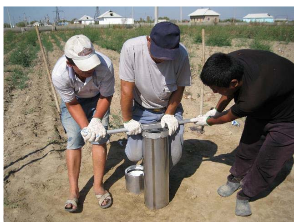
写真 6.3.1 ステンレス円筒体の挿入状況
