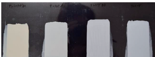
図 14 PET シートに塗膜後の状態。左からサンシクンド BO、サンシクンドリンシード、リンシード BO、リンシード
