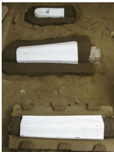
図 4-41 同時に鑄型を成形する
