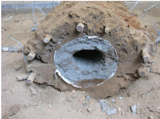
図 4-49 鑄型を合わせて中子を接着する
