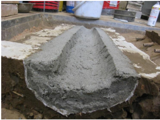
図 4-48 中子砂を盛り付け
