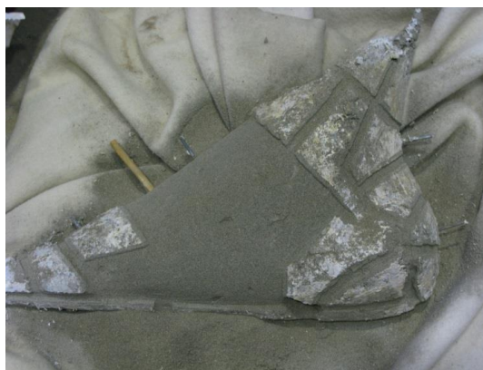
図 1-11 中子に金属の厚みを削る。
