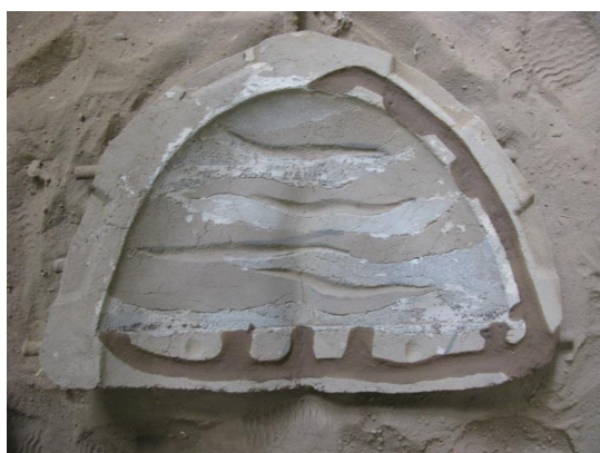
図 3-77 外型に湯道を掘った様子
