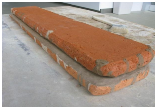
図 2-10 鑄型面をすり合わせる
