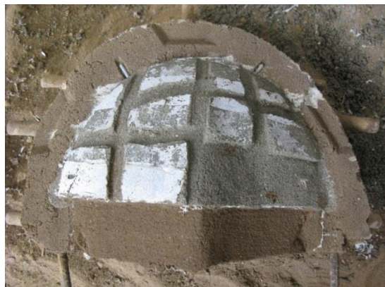
図 3-34 中子を金属の厚み分だけ削る
