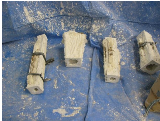
図 4-101 雌型を合わせる
