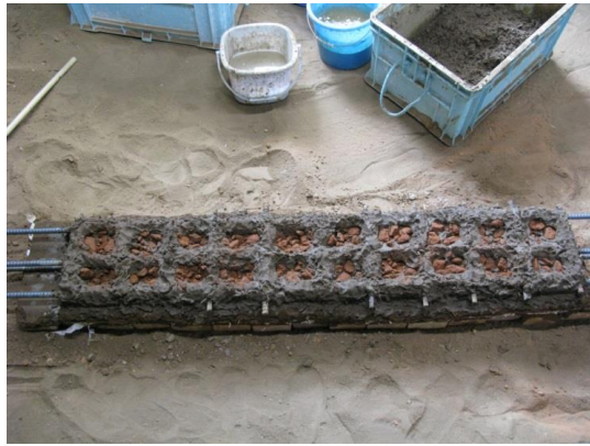
図 4-68 筋金を埋めた状態
