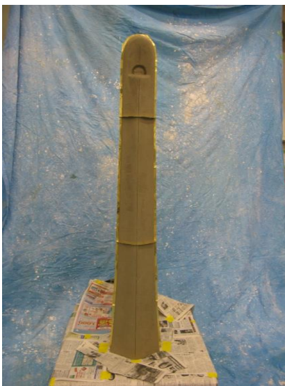
図 4-36 粘土原型に切金を刺す
