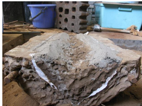
図 4-114 盛られた中子砂の断面図
