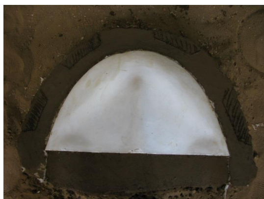
図 3-62 石膏原型を押し台に固定する
