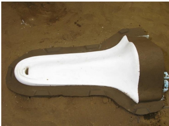
図 4-14 片面の鑄型が完成した様子
