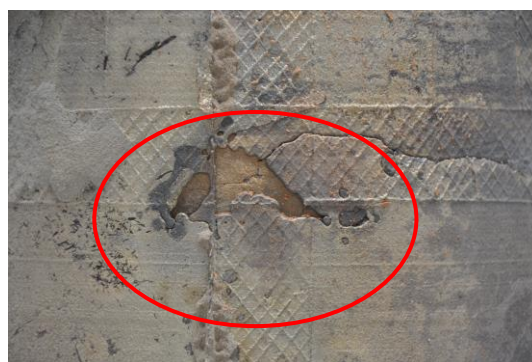
図0-2 湯流れ不良による鑄造欠陥
