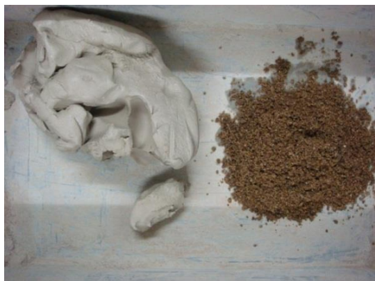
図 2-4 市販粘土と斐伊川の砂を混ぜる
