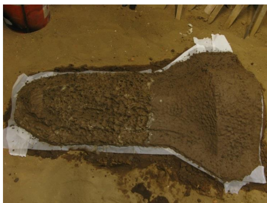
図 4-12 8 番の土間土付け
