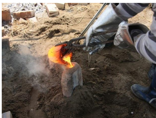
図 2-21 鑄型は半分まで埋める状態で鑄込み
