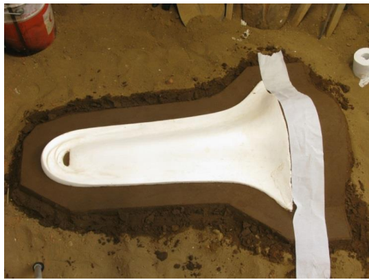
図 4-10 石膏原型を押し台に埋めた状態
