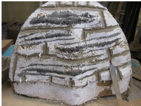
図 3-75 中子に金属の厚みを掘る
