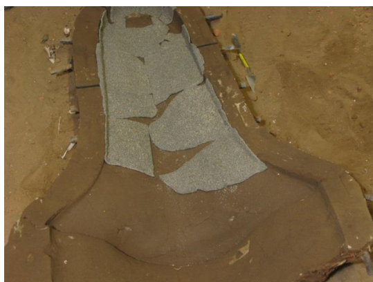
図 4-18 粘土板を鑄型面に張り込む
