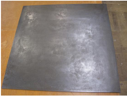
図 4-133 錆を取った鉄板
