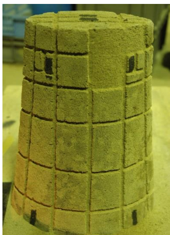
図 2-28 金属の厚みを掘る
