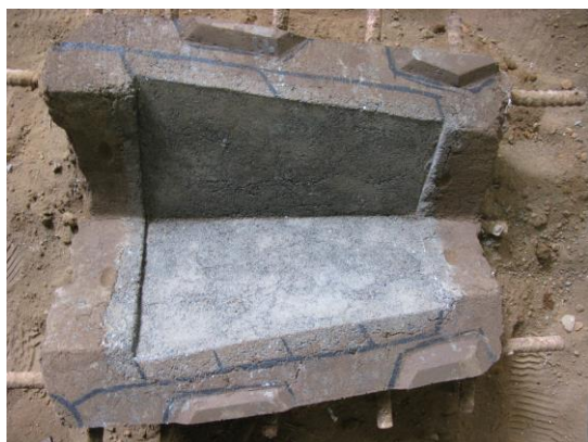
図 4-109 粗い川砂の鑄肌表面
