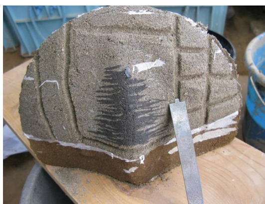
図 3-48 中子に 3 mm の溝を付ける
