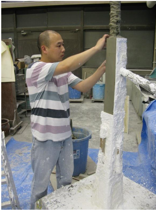
図 4-99 石膏取りの作業（雌型を外す）
