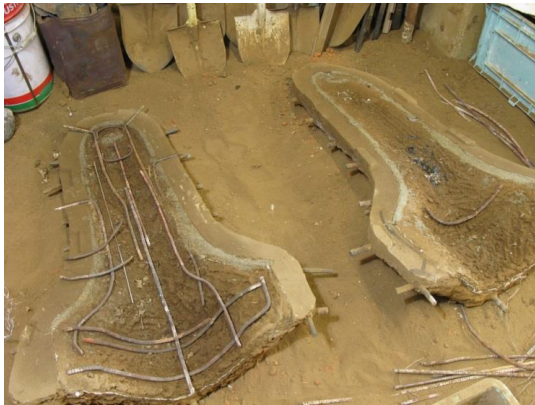
図 4-20 中子に筋金で補強
