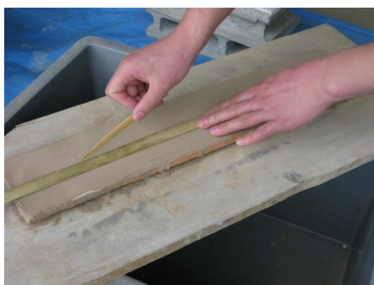
図 2-11 中心線を掘る
