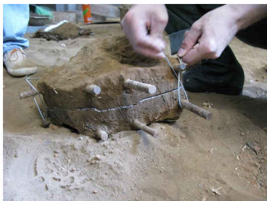
図 3-73 針金で鑄型を縛る
