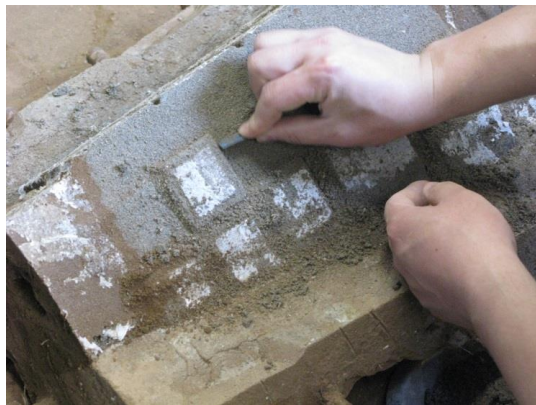
図 4-118 金属の厚みを削る（面取り）
