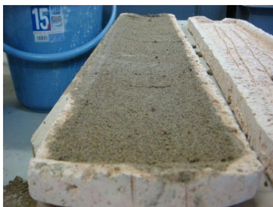
図 2-8 鑄型外枠に粗い鑄型土つけ
