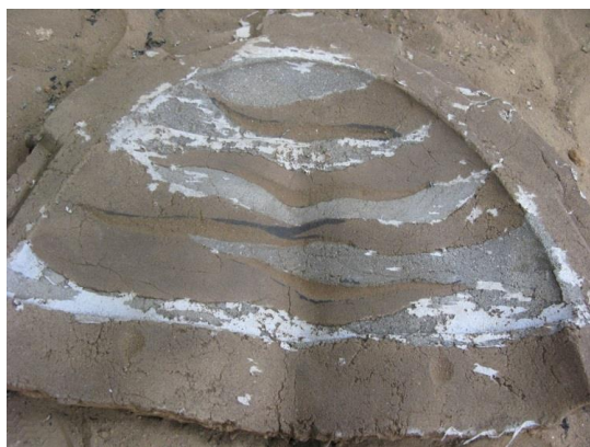
図 3-70 鑄型面に型持ちの位置に溝を掘る
