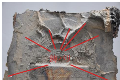
図 0-8 銅鐸鈕の部分に発生した鑄バリ
