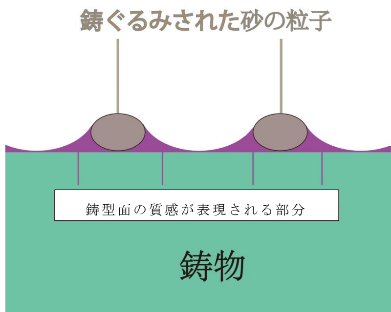
図3-18 鑄ぐるみされた砂粒子のイメージ図
