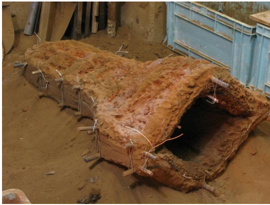
図 4-22 中子の成形で鑄型を合わせた様子
