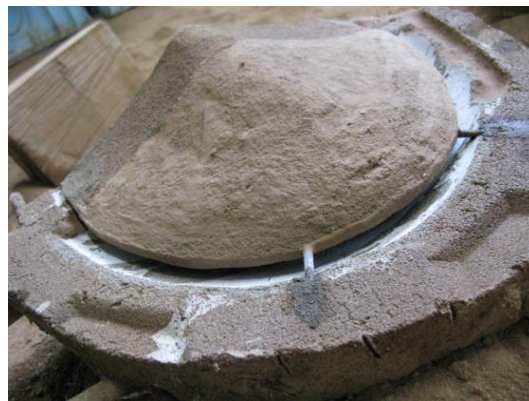
図 3-35 中子と外型の隙間は金属の厚みとなる
