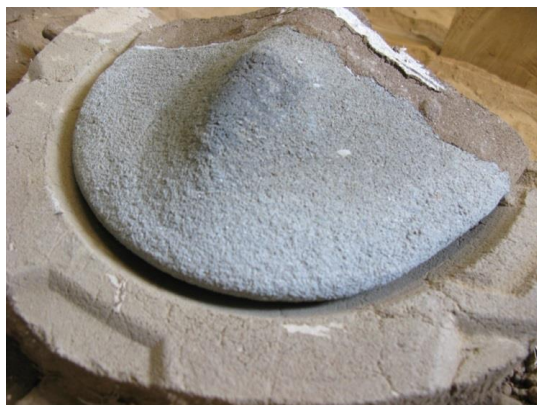
図 3-53 型持ちの再処理
