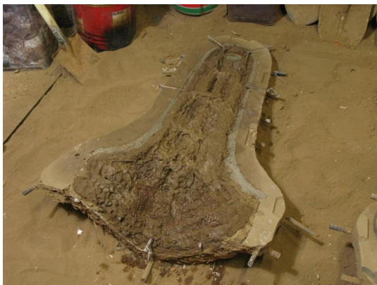
図 4-21 中子の筋金を埋めた様子
