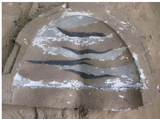
図 3-69 鑄型面に型持ちの位置を決める
