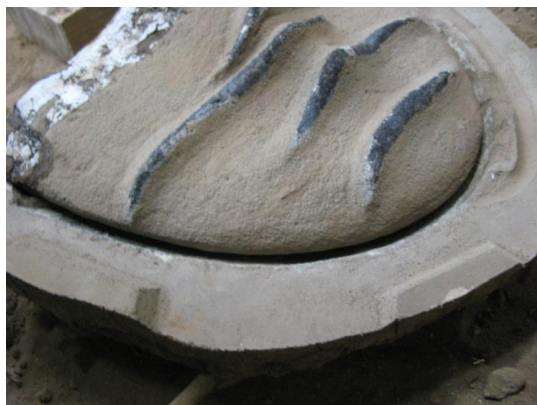
図 3-78 中子を外型に設置した様子
