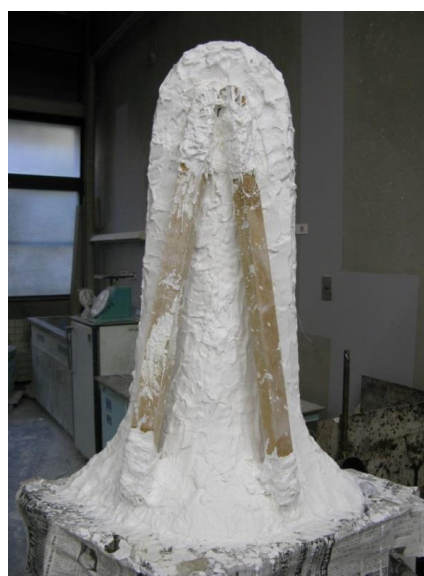
図4-7 木材で石膏の雌型を補強
