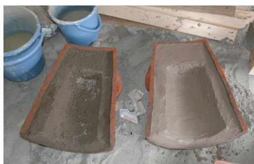
図 2-26 鑄型土詰め(粗い鑄型土、中土)
