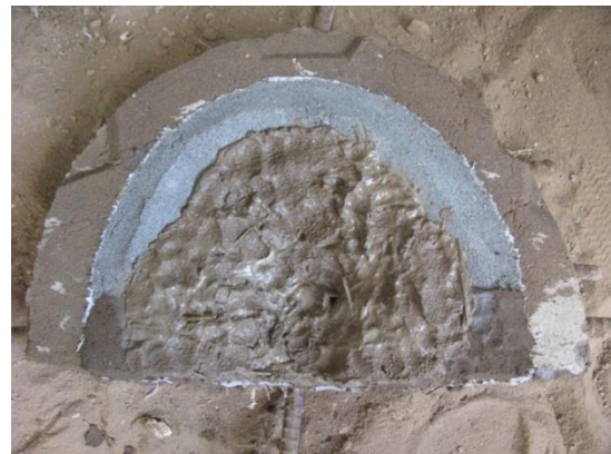
図 3-44 粗い鑄型土で補強
