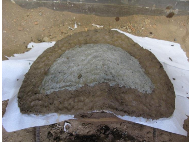
図 3-58 海砂と川砂を混ぜ合わせた鑄肌砂
