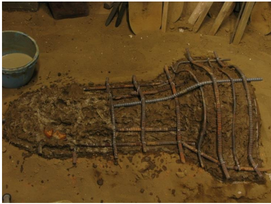
図 4-13 鑄型を筋金で補強
