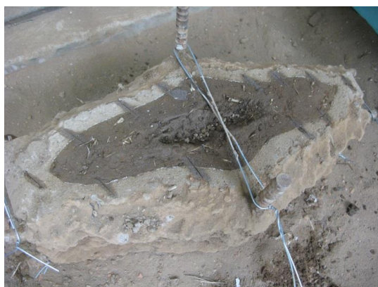
図 3-74 外型と中子に合わせ目を付ける
