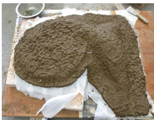
図 1-6 木を支える針金を鑄型に打つ
