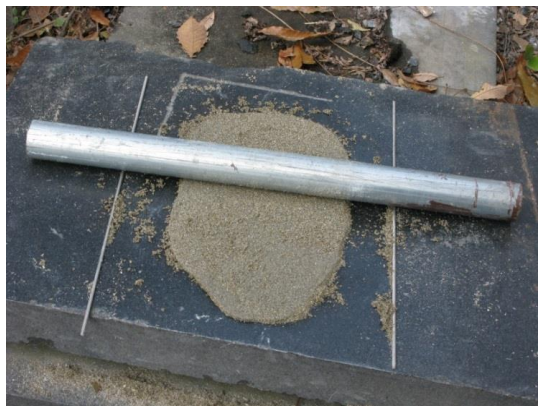
図 4-17 金属の厚みとなる粘土板
