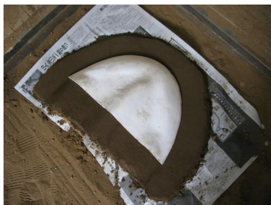
図3-28 石膏原型を押し台に埋める
