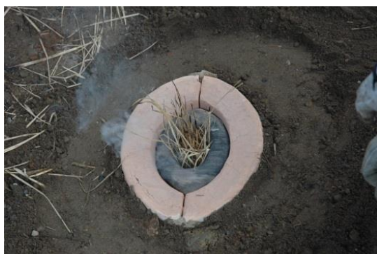
図 2-31 鑄込み前の鑄型の設置
