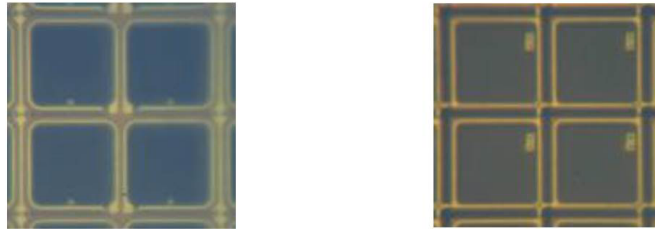
図 17: 新型 MPPC の写真。トレンチ構造を持たないもの（左）と持つもの（右）。ピクセル境界部の黒く見える部分がトレンチ。
