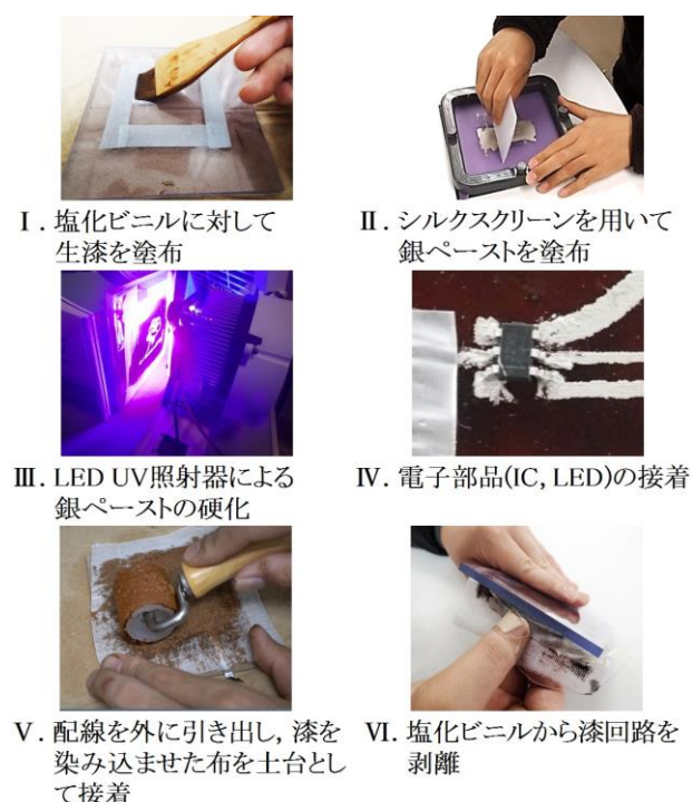
図6 カバー型漆タッチインタフェースの製作手順
