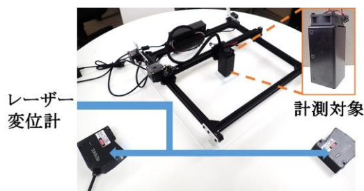
図25 XY ステージにおける繰り返し精度検証実験の構成 Fig.25 Configuration of repeat accuracy verification experiment in the XY stage
