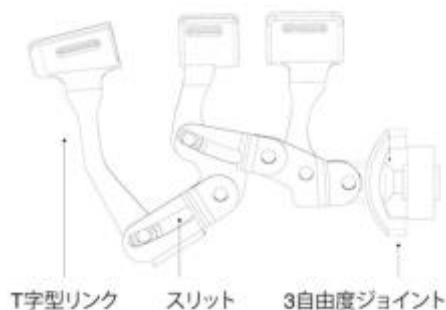
図 10 手指リンク機構の概要 Fig. 10 The drawing picture of the links
