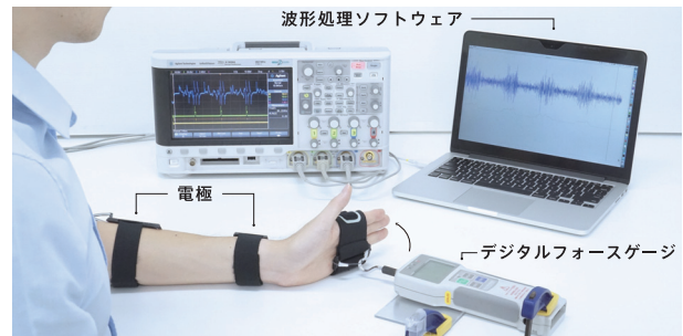
図11 計測性能評価: 構成 Fig. 11 Experimental Setup
