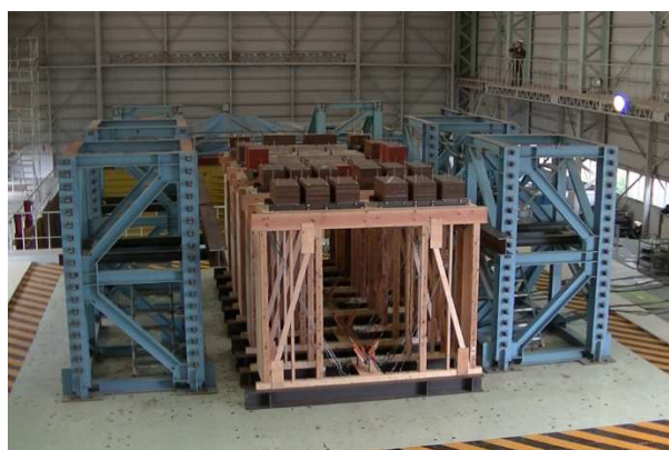
図 3.15 試験体設置状況（壁仕様変動シリーズ）
