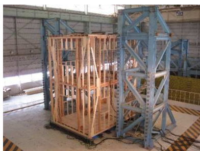
図3.2 平面寸法縮約の基にした試験体
