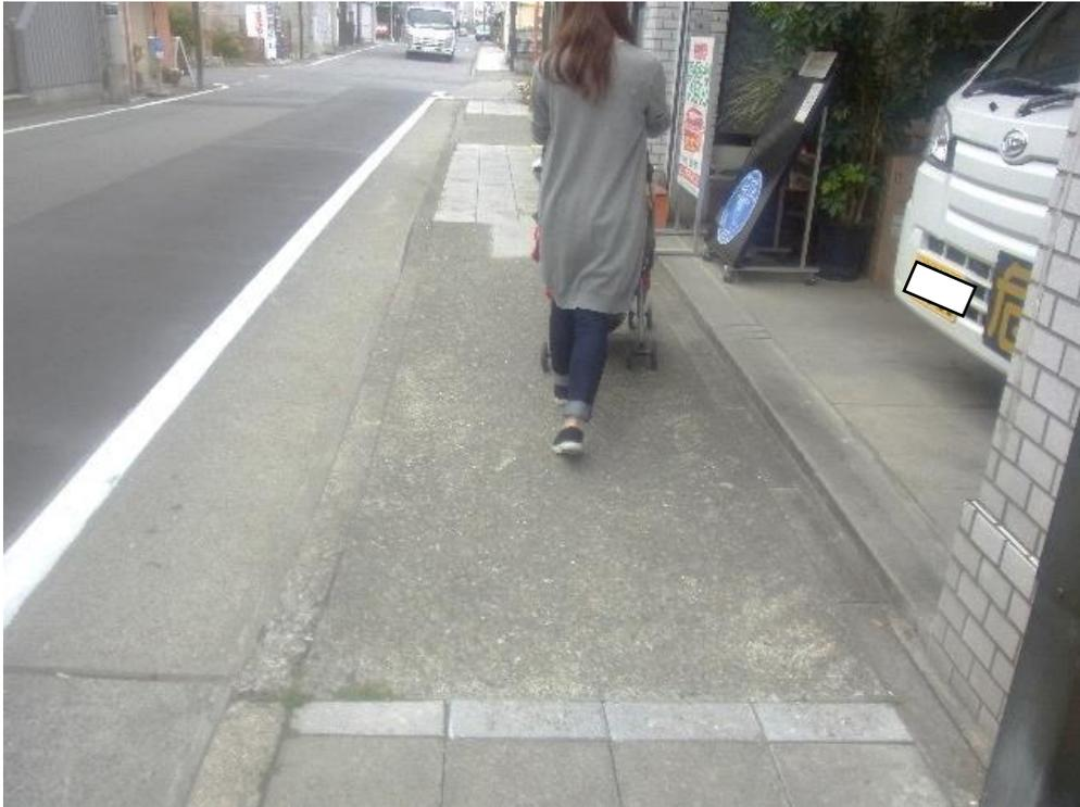
写真 4-2-58：車道との段差をなくすために傾斜が設けられている歩道（高崎市南町）
