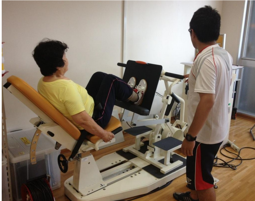
Figure 3-2. サーボ制御式膝・股関節ダイナモメータ筋力測定器 (相羽ら, 2015).
