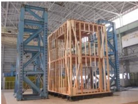
図1 振動実験(1)試験体全景
