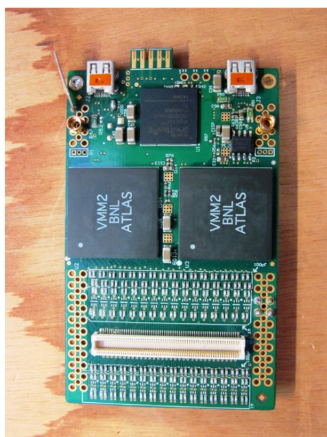
図 8 : ATLAS BNL グループが開発中の VMM2 チップ。CERN-RD 51 グループと共同で FOCAL 検出器用に開発・改良を行っている。
