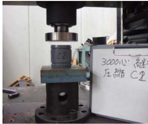
写真 4.4 継手圧縮試験 1)
