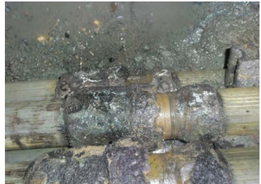
写真4.9 実際の地盤変状による管路被災
