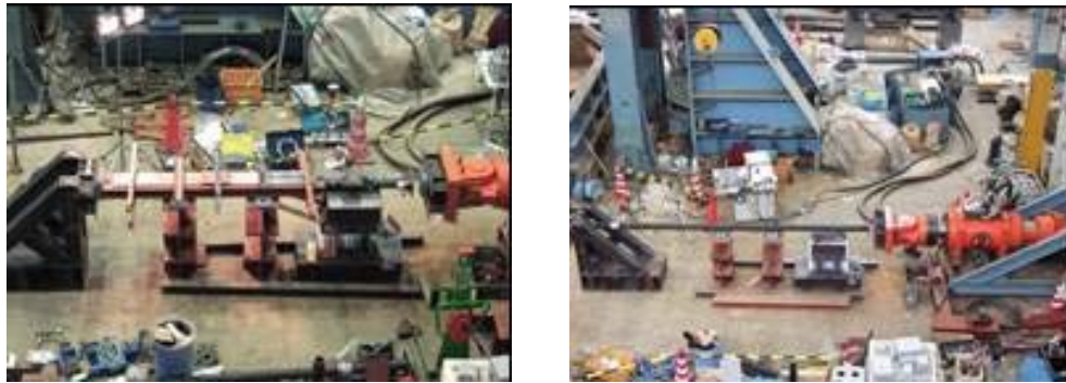
写真 4.6 検証実験状況(左:ねじ継手圧縮, 右:ねじ継手引張)
