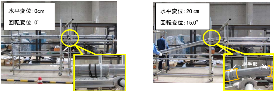
写真 4.10 地盤追従性実験状況
