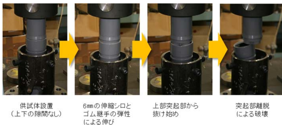
付図 2-11 引張によるライニング管継手の状況
