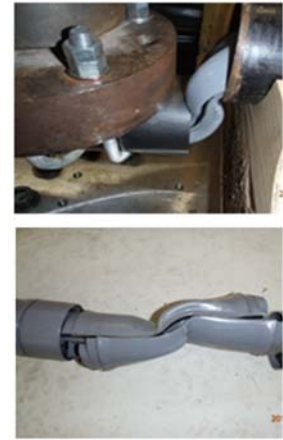
(a) ケース 1 (左: 空間限界荷重 中: 破断荷重 右: 破断状況)
