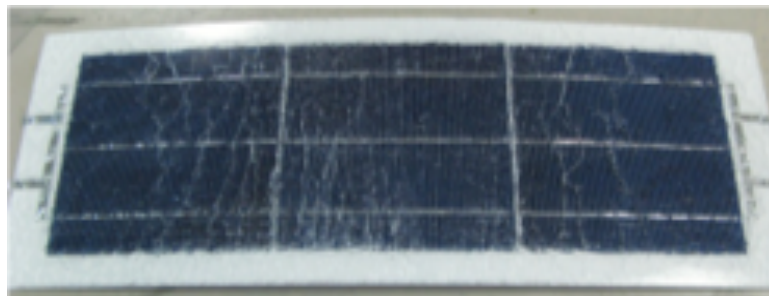
図 4.14.2 点荷重, 5 kN でガラス割れが発生したモジュールの外観
