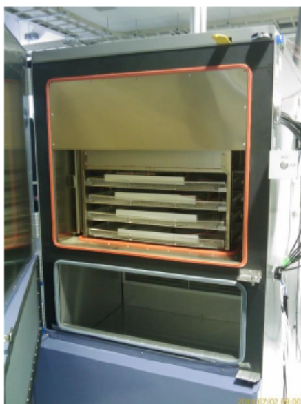
図 3.9. TSD-100 の外観と太陽電池モジュール設置状況
