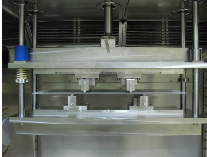
図 4.9. BCL 装置への PV モジュール設置状況
