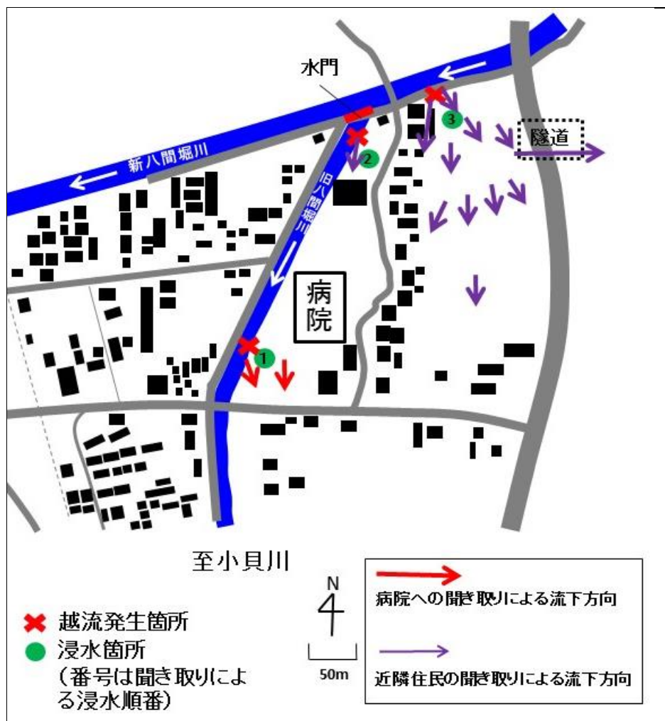
図 6-10 八間堀川分派点付近の浸水状況
