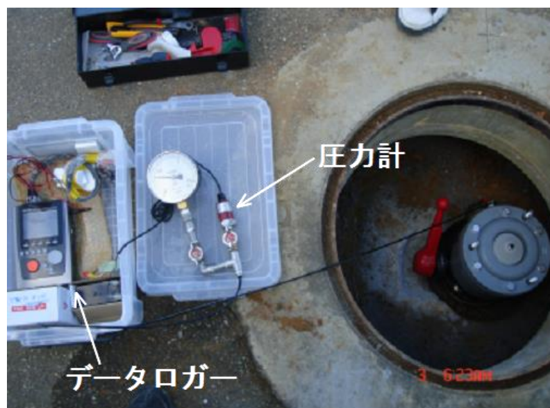
図 3-6 圧力計の設置状況
