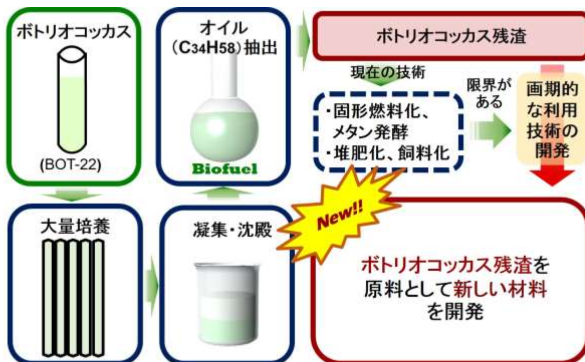
図 2. 1 ボトリオコッカス残渣が得られるまでのプロセスおよびそれを原料とした新しい材料開発へのシステム構築
