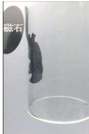
図2．5 炭素化後のボトリオコッカス残渣が磁石に引き付けられる様子。
