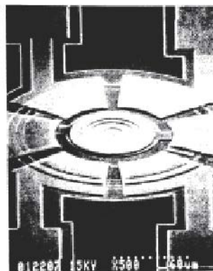
Figure 1.1 Si多結晶により構成されたマイクロモータ。 (Reprinted with permission from ref. 1. Copyright 1988 IEEE.)
