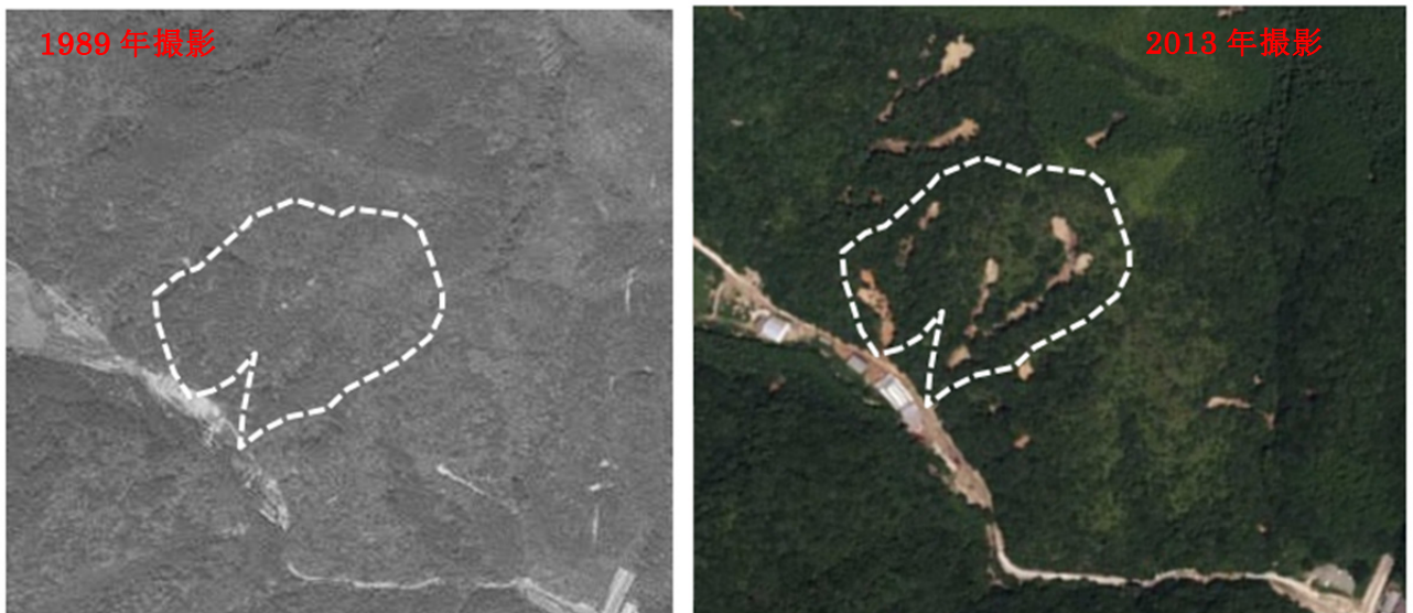
図 3.26 対象箇所の過去の崩壊発生状況(山口北部)
