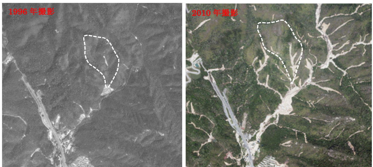
図 3.24 対象箇所の過去の崩壊発生状況(防府)
