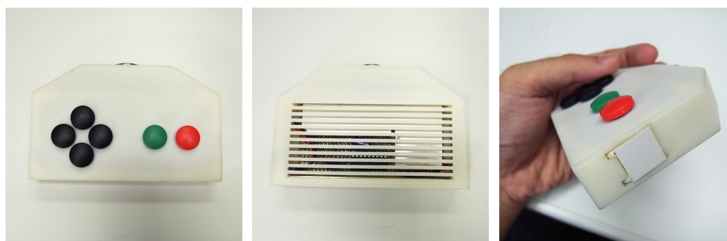
図4-53 左：コントローラ前面，中央：コントローラ背面，右：側面に配したペルチェ素子[117]より許可を取り引用
