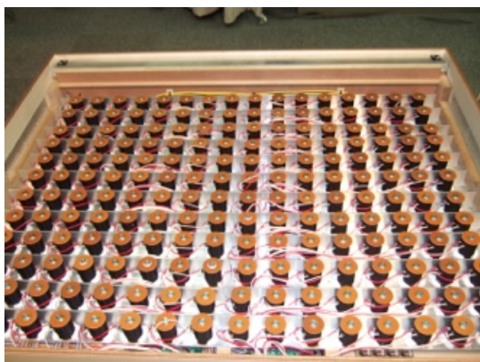
図5.3 躯体内部のソレノイド配置状況
