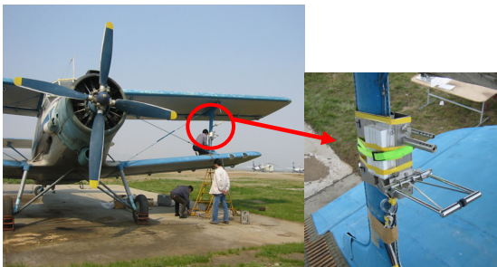
図2 航空機に設置した温湿度センサ
