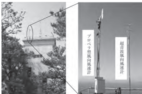
第1図 プロペラ型風向風速計と超音波風向風速計の設置状況
