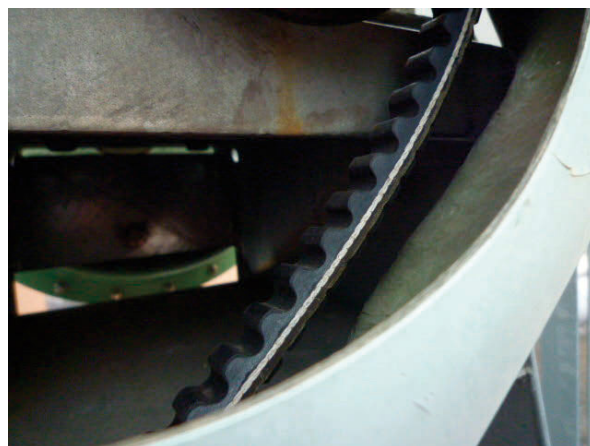
図5. 緩み、型式も異なっていたファンベルト
