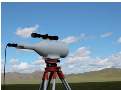
モンゴル半乾燥草原における大口径シンチロ メータによる顕熱フラックスの広域観測. (2003年8月22日)
