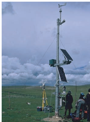
RAISE プロジェクトによって、モンゴル半乾燥 草原のヘルレンバヤンウランに設置された、 自動水・熱・炭素収支観測システム. (2011年3月22日)
