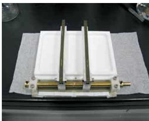
図2 製作した小型の界面活性剤圧縮装置
