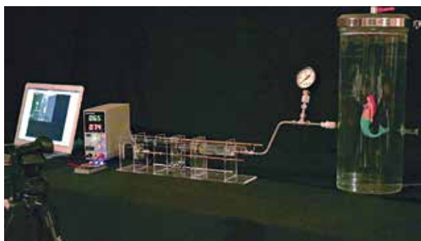
図4 浮沈子をPID制御している様子
