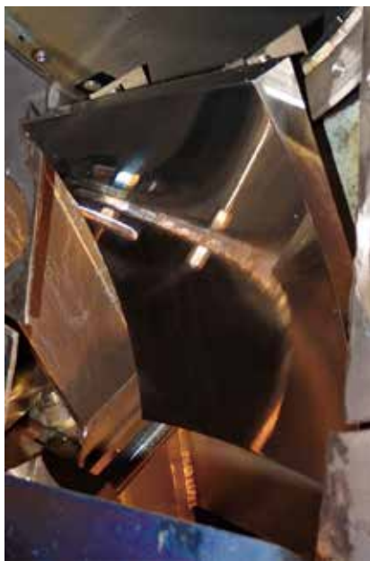
図8 ガンマ10プラグ部に適用した 新型ミラー・アンテナM2。
