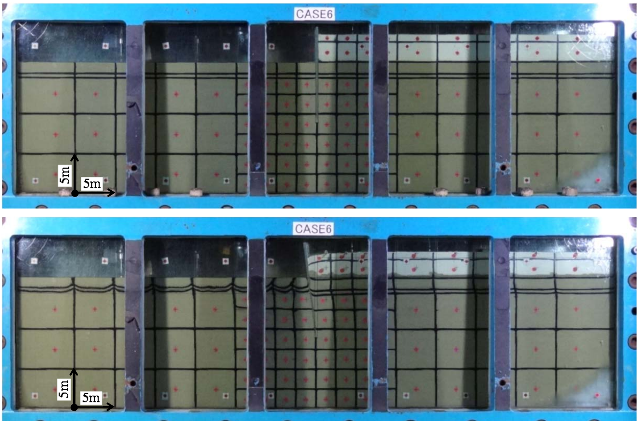
図-巻. 2(3) 各ケースの加振前後の模型写真 (上: 加振前, 下: 加振後)
