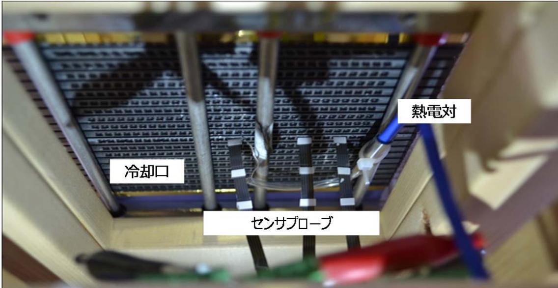
図 3-7 冷却口へのセンサ挿入図(Under View)
