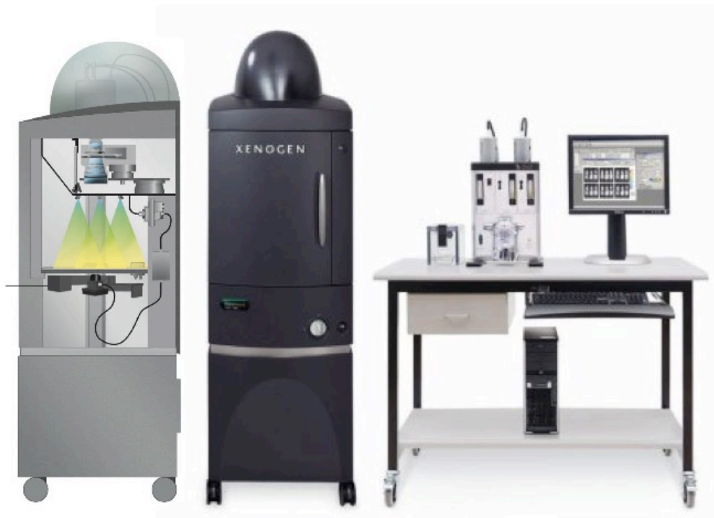
図 3. Xenogen IVIS Spectrum (PerkinElmer Inc., Waltham, MA, USA) とその内部構造
