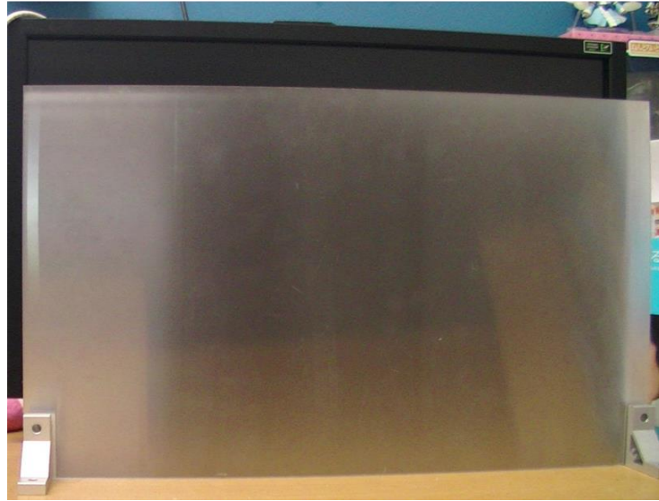
図 3.7 ドットマトリックス光源の正面に鉛直方向拡散板を設置した図
