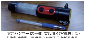
「緊急ハンマー」の一種。突起部分(写真右上部)を使えば簡単に窓ガラスを割ることができる
