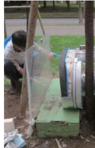
樹木用MRIでケヤキの木を挟み、樹液の流れを測定する寺田准教授ら。同准教授提供
