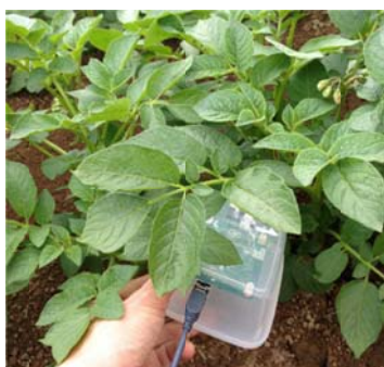
図 4-4 apras に格納した現場測定データの閲覧画面の例。(左図:超小型分光センサによる透過光スペクトラムデータの収集. 右図:スマートフォンでの閲覧例)
