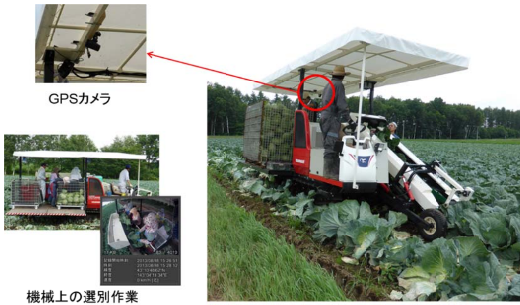
図 4-7 GPS 機能付きカメラを設置したキャベツの収穫機
