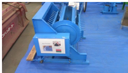
写真Ⅱ-9 農業機械研修を通じて改良された足踏み脱穀機（於：JICA 筑波）
