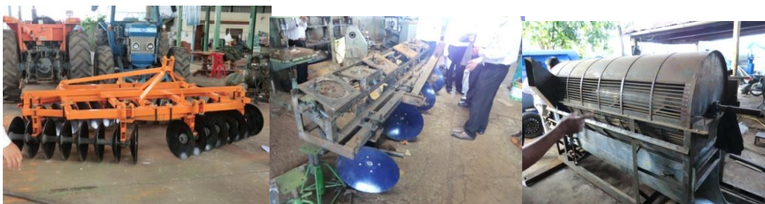
写真Ⅱ- 24 ディスクプラウ 写真Ⅱ- 25 レベラー 写真Ⅱ- 26 脱穀機
