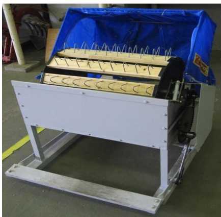
写真Ⅱ-5 製作足踏み脱穀機（於：JICA 筑波）
