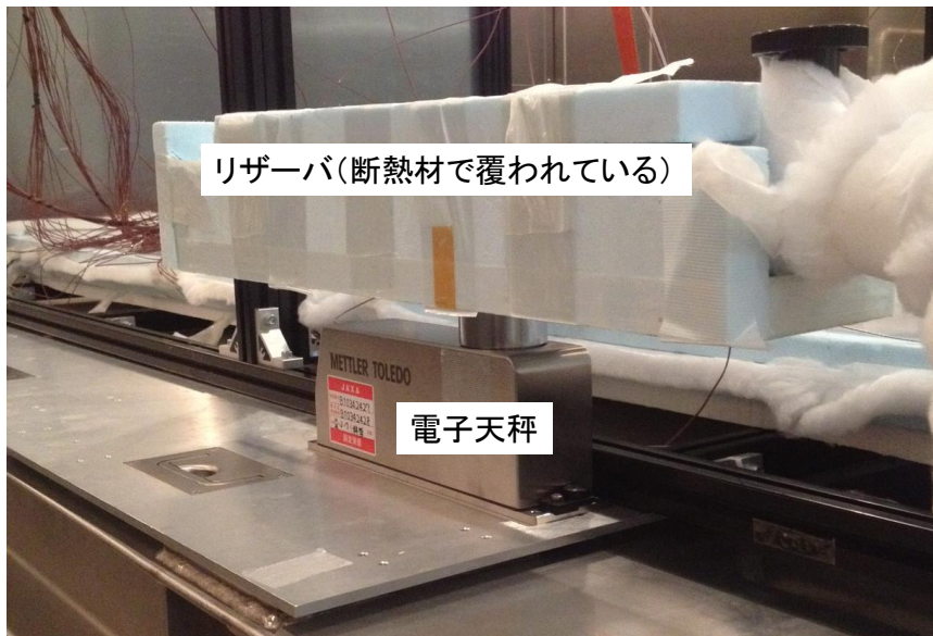
図 2.3.2.1 リザーバ重量の計測方法
