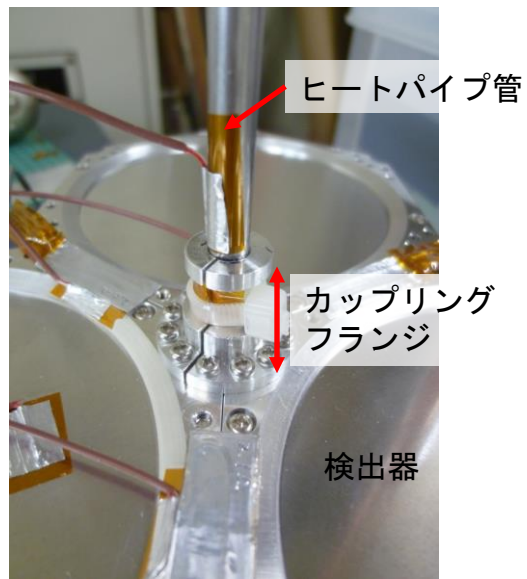
図 5.3.3.1 ヒートパイプ管と模擬検出器の結合写真
