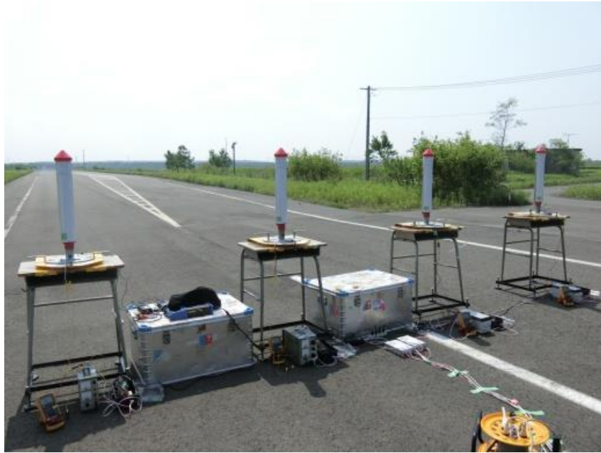
図 67 視認性試験の特殊信号発光機設置状況
