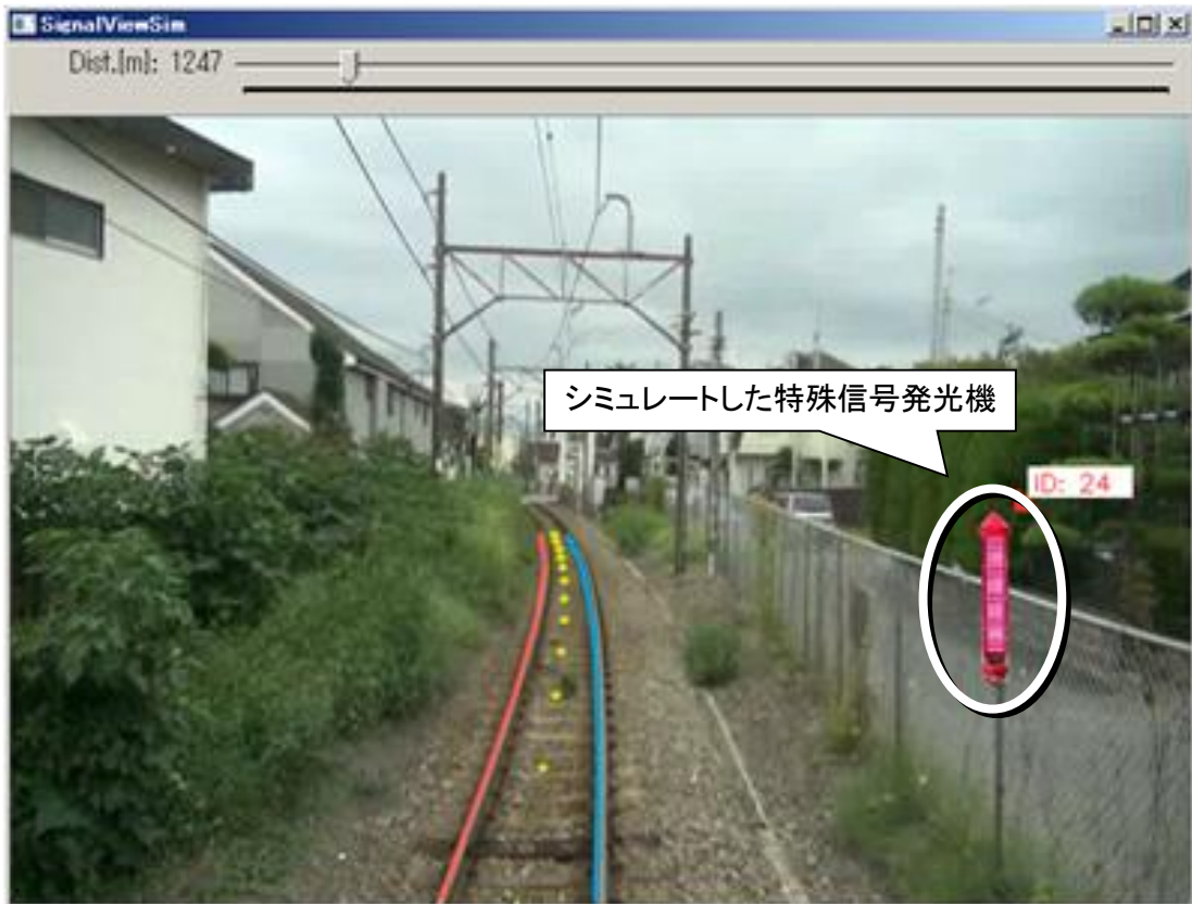
図 87 列車前方映像への特殊信号発光機の表示結果その 2
