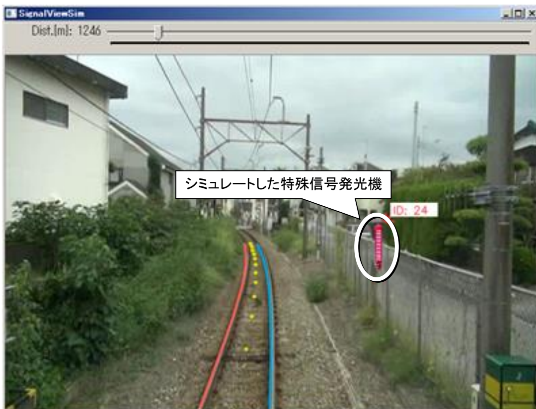
図 86 列車前方映像への特殊信号発光機の表示結果その 1
