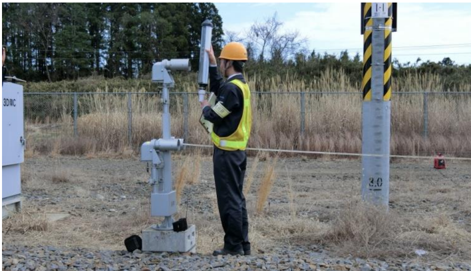
図 71 大型支障物検知装置への影響評価試験風景
