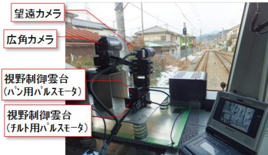
図 9 カメラ視野制御装置の構成
