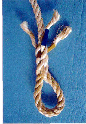
図45 バック・スプライスの要領で更にもう一段撚り込む。
