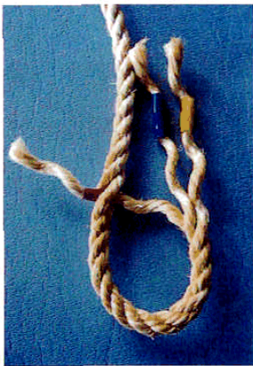
図41 解いた子繩のどれか一本を人差指に置き繩本体に撚り込む。
