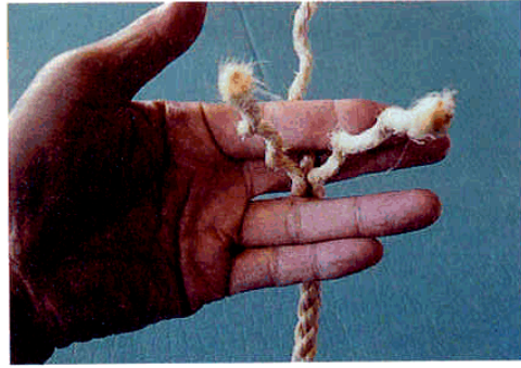
図30 三本の子縄を手前2本、反対側1本になるように人差指で分ける。
