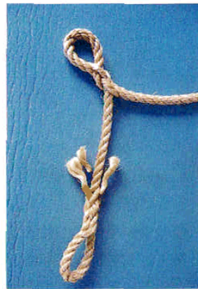
図48 子縄通しによる輪の完成。
