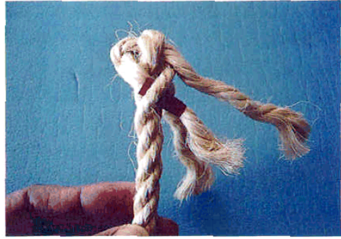
図36 指の先に子繩を乗せ親指で押し込む。
