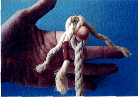
図35 バック・スプライスの開始（解いた子繩の真下にある二番目の本体子繩を緩め、指を入れる）。
