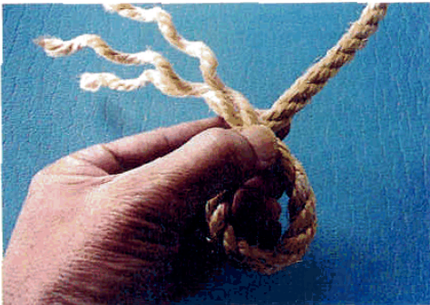
図39 アイ・スプライスの開始（解いた子繩の根元を繩本体に重ね、内径3cm位の輪になるような位置を確認する）。
