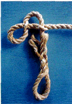
図47 ロープが十文字に交差している場所で今度は、通した方のロープに蛇口を通す。
