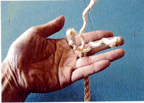
図29 クラウンノットの開始（中指と薬指の間に解いたロープを挟む）
