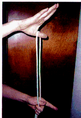
図1 ロープの中央を右手親指に掛け50cm位下方を左手で握る。
