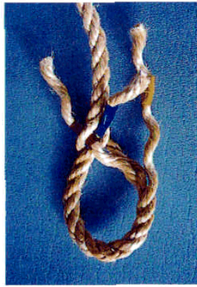
図42 最初に撚り込んだ子繩の真下にある本体子繩を緩め、二番目の子繩を下から上に通す。
