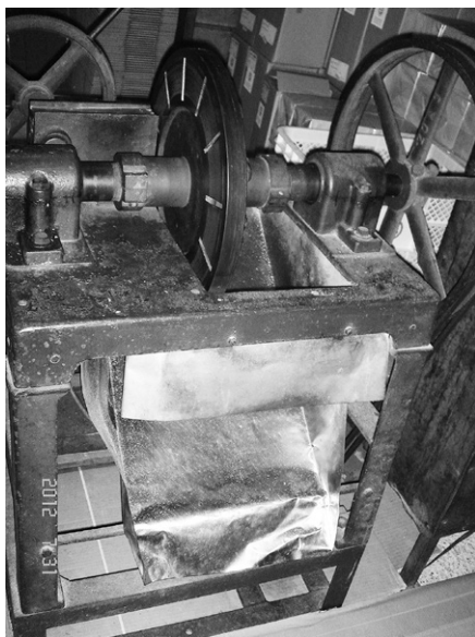
図4 Z社製削りかまぼこ専用の削り機械
