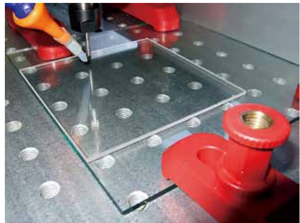
図11 工作物の固定作業
