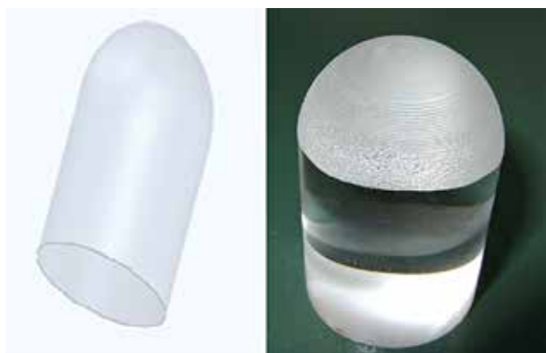
図17 CADソフト3D画像と試作品（右写真）
