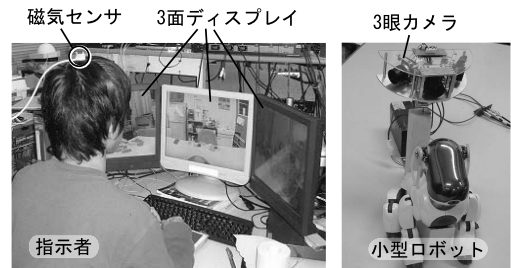
図 5 指示者側システム (左) と小型ロボット側システム (右) Fig. 5 Systems of an instructor's site (left) and a small robot's site (right).
