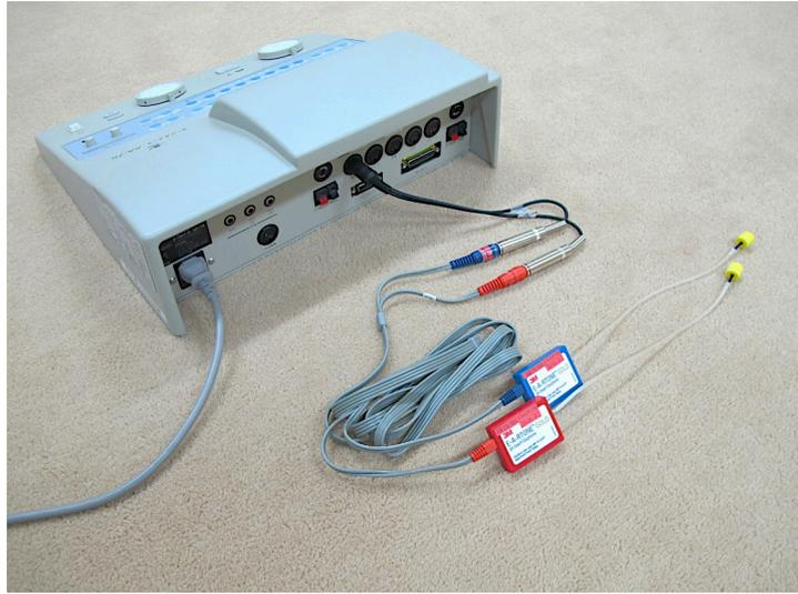
図 2-1 AA-76 へのインサートイヤホンの接続
