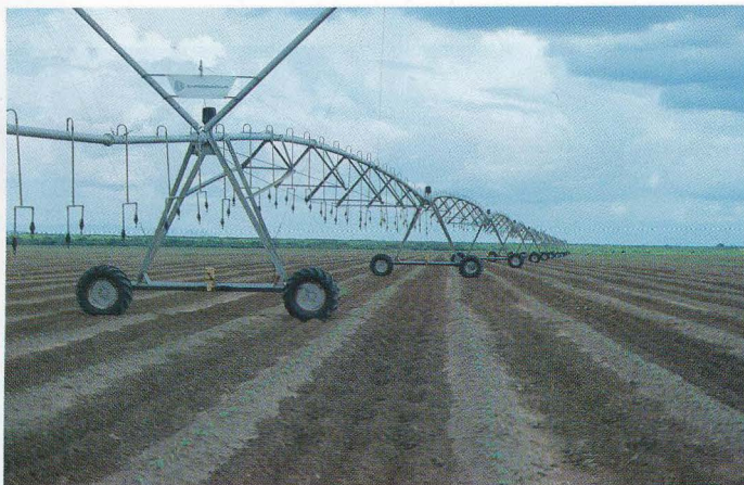
写真6 センターピボッド灌漑システムの構造（1990年1月） ほぼ50m毎に支柱を支える三角の車輪があり、下についた動力で車は動く。 灌漑用水は中心軸（Center pivot）から供給され、腕に取り付けられたスプリンクラーで散水される。栽培作物はスイカ。
