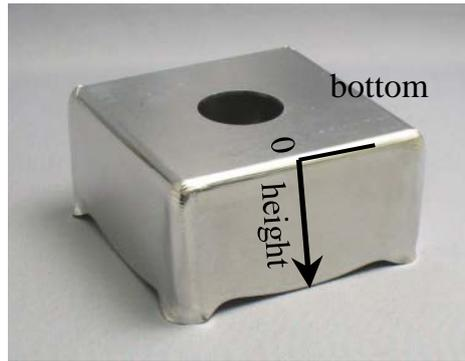
Fig. 3-17 回転パスセットによる角筒形状の成形品
