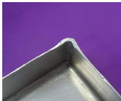
**Fig. 2-20** 角筒形状の成形品の断面
