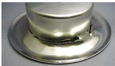
**Fig. 3-12** 破断箇所（移動量 0.06、成形高さ 45 mm）
