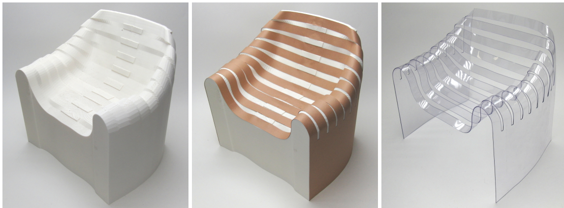
図 4.14: 3D プリンタで出力したサポート部材とその表面に貼り合わせた画用紙、形成した塩化ビニル板; サイズ (W/H/D): 247 × 233 × 179mm.
