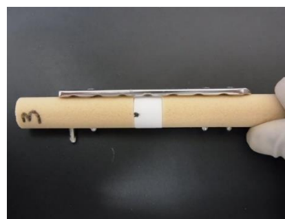
図 8. 皮質骨部分欠損モデル 2 群の模式図及び模擬骨模型の写真 (左: 応力遮蔽群 右: 負荷群)
