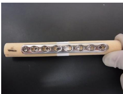
図 8. 皮質骨部分欠損モデル 2 群の模式図及び模擬骨模型の写真 (左: 応力遮蔽群 右: 負荷群)
