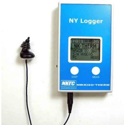
図 2-7. 耳栓型温度計
