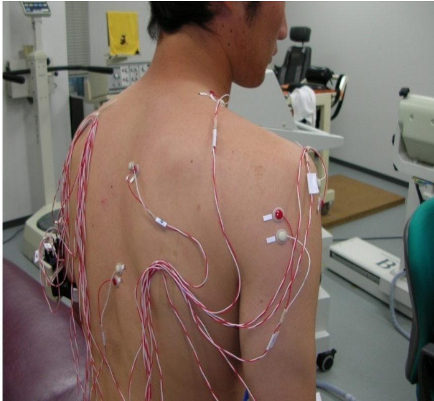
Figure2-2 筋電図測定筋は上腕二頭筋, 三角筋(前部, 中部, 後部), 僧帽筋(上部, 中部, 下部) 大胸筋の8か所で行った.
