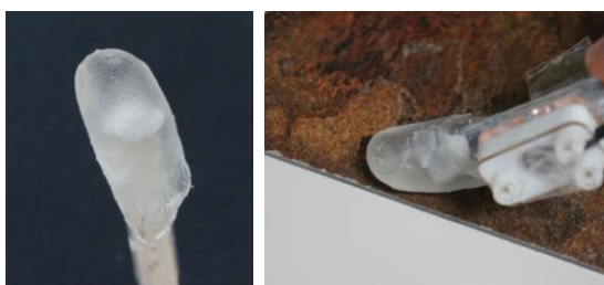
図 3 弁別可能性評価のための振動取得装置
