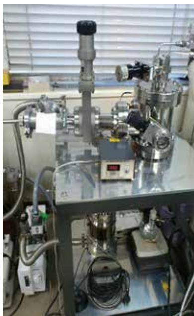
図6 稼働中のALD装置。右上に写っているのが成膜チャンパー。この内部にサンプル加熱台などがある。
