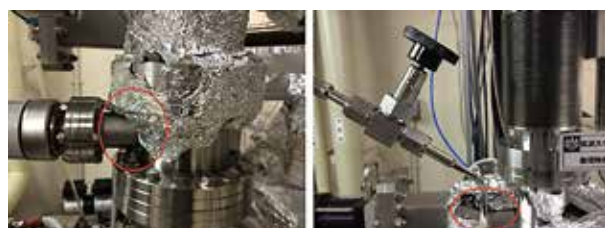
図4 左：真空ゲージ用ポート 右：リークバルブ
