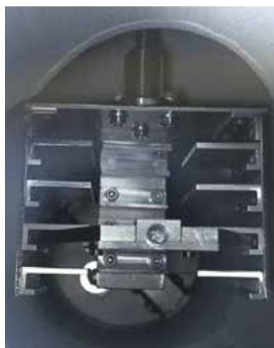
図5 MBE準備室のサンプルホルダー棚。ステンレス板などを旋盤を用いて加工し、ネジで組み立てている。これ全体を引き上げる機構も自作。
